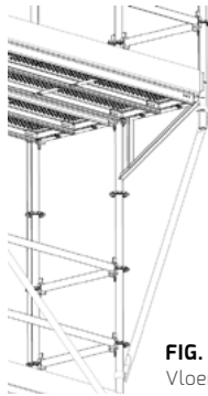
FIG. 3.19 Vloer verbreed met console van 0,36 m
